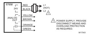
Fig. 14. Wiring the C7232.
